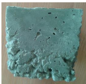
Рисунок 1 – Расслоение бетона с В\Ц 0,6 с 5% опоки
