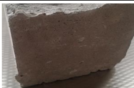
Рисунок 2 – Образцы бетона на основе природной (1) и обожженной(2) опоки.
