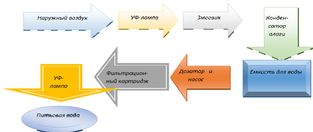
Рис. 3. Принцип работы генератора воды.
